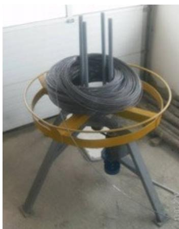
Napravljeno je od varene čelične konstrukcije sa centralnim uležištenjem, koje može da primi i asimetrično opterećenje prilikom utovara kotura, ručno ili mehanizovano.
