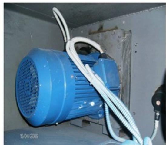
Svi ovi uređaji koji sadrže obrtne delove zaštićeni su limenim štitnicima da bi se sprečile eventualne nezgode. Mikroprekidač onemogućuje pokretanje doboša dok se njegov poklopac ne zatvori.
