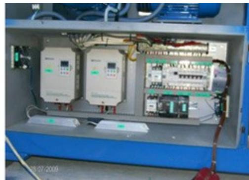
U pultu su pored procesora smeštene i sve komande mašine. Pult je mehanički zatvoren i zaptiven tako da prašina koja se javlja prilikom rada mašine ne oštećuje procesor. Elektroormar je smešten u zadnjem delu mašine. U njemu se nalaze frekventni regulatori za podešavanje režima rada mašine.
