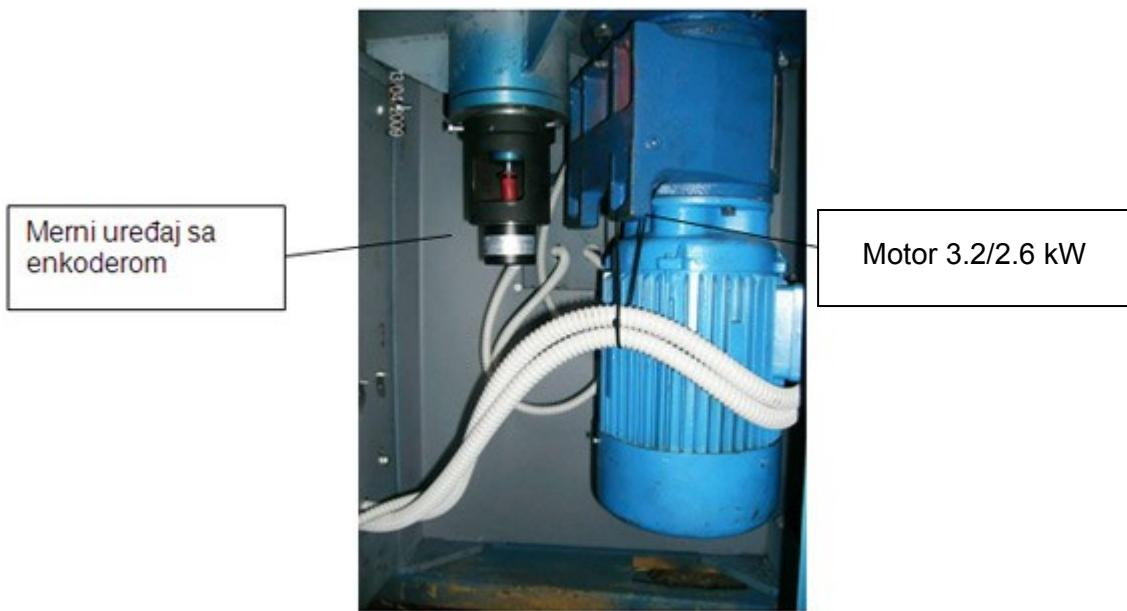
Rad motora se reguliše pomoću frekventnog regulatora snage, čime je mašina dobila na kvalitetu i pouzdanosti rada.
