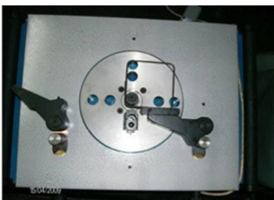
Taj alat se postavlja na nazubljenu pločicu u glavi a zazor između centralnog bolcna i odbojnika se podešava pomeranjem odbojnika. Ovaj alat se isključivo koristi pri savijanju tanke armature (manje od 20 mm). Koristi se centralni bolcn sa manjim prečnikom.
