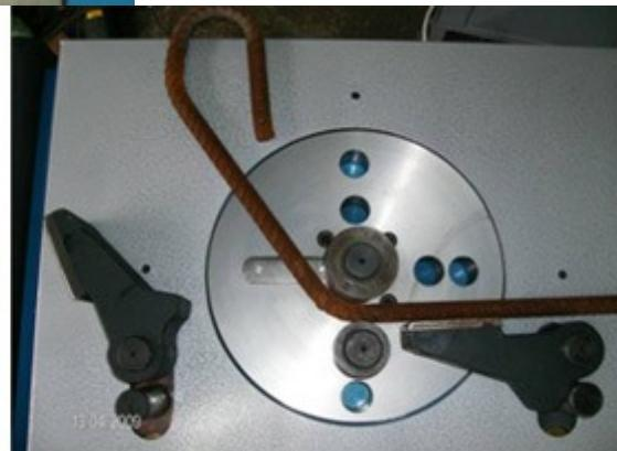
Savijanje debele armature prikazano je na prethodnim slikama. Prema profilu armature odaberu se bolcnovi i čaure a odbojnik se dovede u položaj da stoji horizontalno, odnosno paralelno sa pravcem armature. Drugi odbojnik se skloni u stranu. Izabere se ugao i brzina savijanja i pritiskom na nožnu komandu izvrši savijanje. Ukoliko nismo zadovoljni uglom savijanja izvrši se njegova korekcija.
